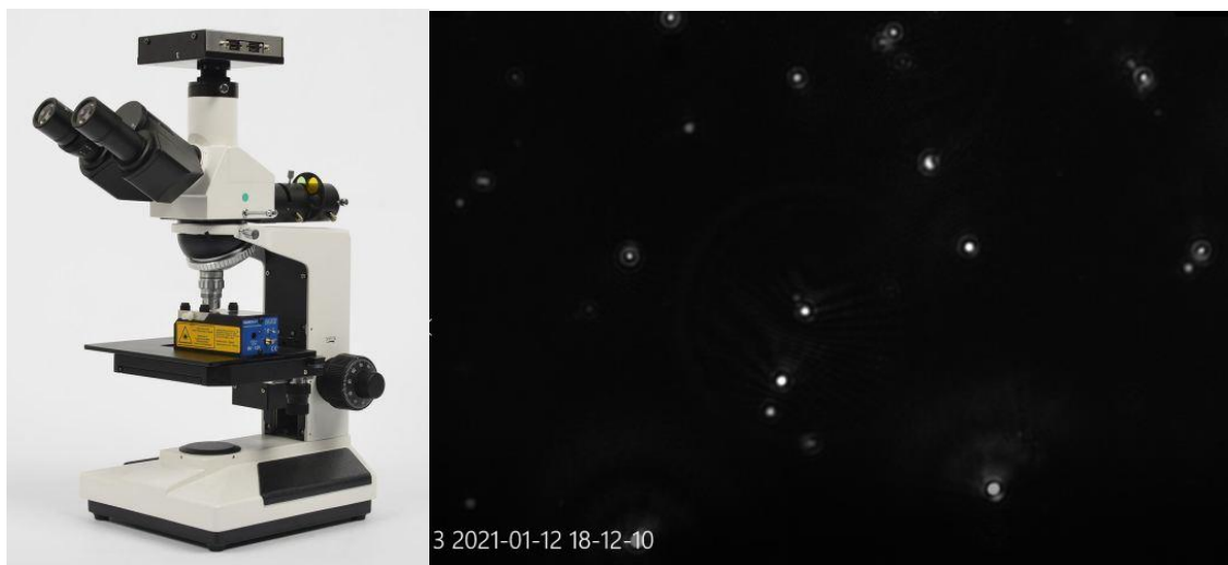
Ryc. 9. A - aparatura wykorzystywana w obrazowaniu NTA. B - obraz spod aparatury NTA ukazujący otrzymane nanocząstki gentamycyny. Zdjęcia własne.
