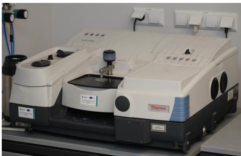
Ryc. 7. Spektrometr do analizy widm w podczerwieni Nicolet 6700 Thermo Scientific. Zdjęcie z katalogu producenta.
