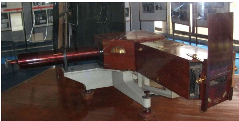
Ryc. 1.6.2. Pierwszy spektrometr używany przez C.V. Ramana (fot. z archiwum własnego Malwiny Birczyńskiej-Zych).
