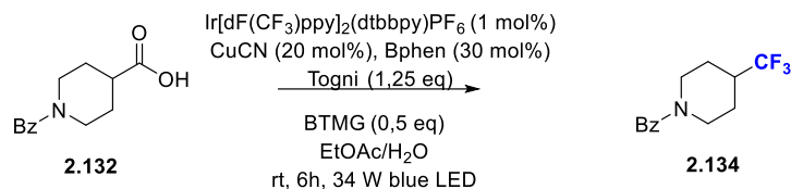
Schemat 2.34 Fotodekarboksylacyjne trifluorometylowanie – MacMillan (Bphen – batofenantrolina, BTMG – zasada Bartona - 2- tert -butylo-1,1,3,3-tetrametyloguanidyna).
